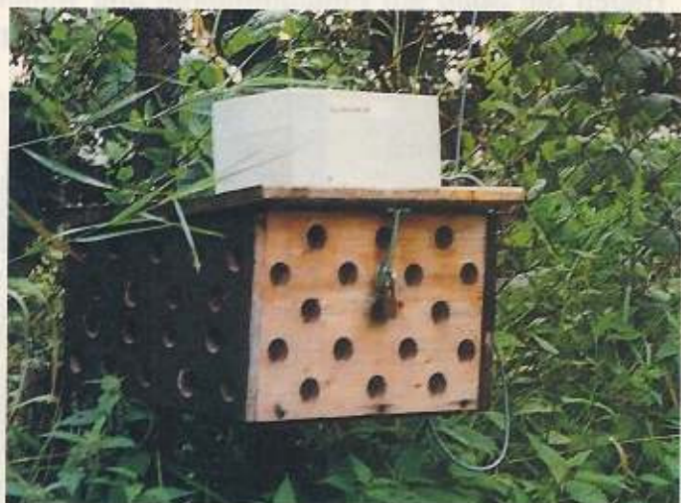
Bild 1. Das Geiger-Zählrohr befindet sich in einer Art Vogelhaus. Radioaktive Strahlungen werden hier gemessen und die erzeugten Stromimpulse an den Userport des VC 20 weitergegeben.
