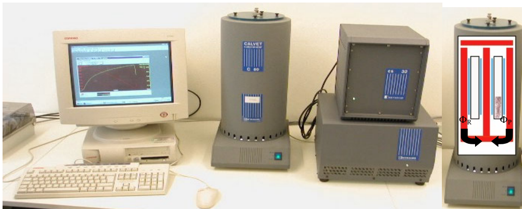
Abb. C.2: Messanordnung und Messprinzip des Wärmestromdifferenz-Kalorimeters. Die Messapparatur besteht aus vier Komponenten: Rechner, Kalorimeter sowie dem Controller und dem Netzteil (von links nach rechts).
