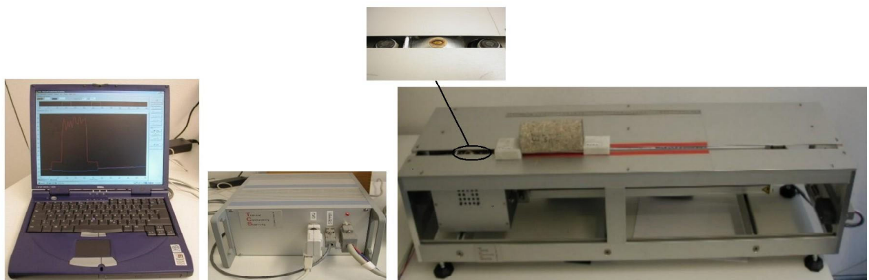
Abb. C.1: Messanordnung des Thermal Conductivity Scanners. Von links nach rechts sind der Auswertungsrechner, die Steuereinheit und das eigentliche Messgerät zu sehen. Der kleine Ausschnitt lässt die beiden beweglichen Sensoren („kalt“ und „heiß“) mit der dazwischen liegenden Wärmequelle erkennen.
