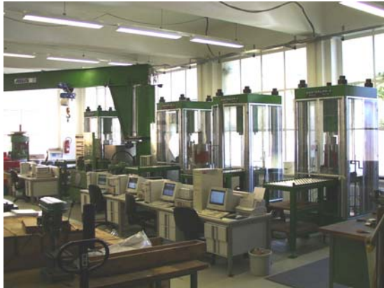
Bild 4.1: Triaxialprüfstände der Professur für Deponietechnik und Geomechanik
