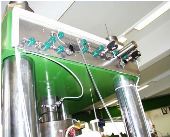
Bild 4.3: Permeabilitätsmesssystem und schematisiertes Messprinzip
