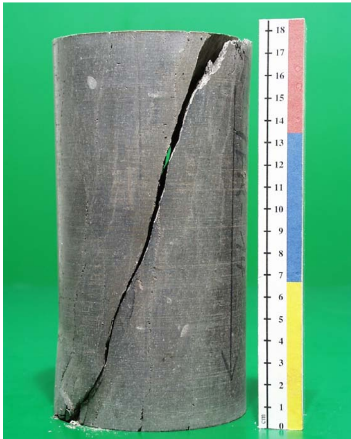
Bild 4.13: Prüfkörper nach dem Versuch, Schichtung parallel
