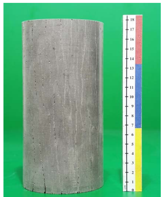
Bild 4.10 Tonsteinprüfkörper – Schichtung parallel zur Prüfkörperachse
