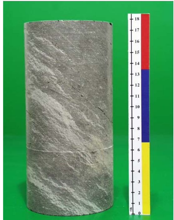
Bild 4.11 Tonsteinprüfkörper – Schichtung unter 45° zur Prüfkörperachse
