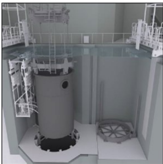
Ausheben des Unteren Kerngerüsts
